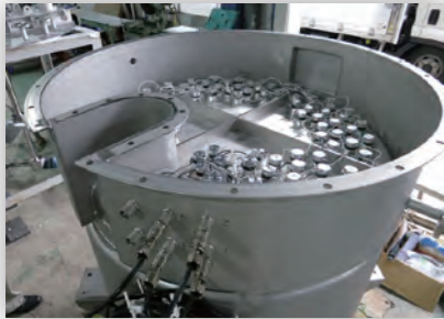
攪拌槽下部超音波振動子部
