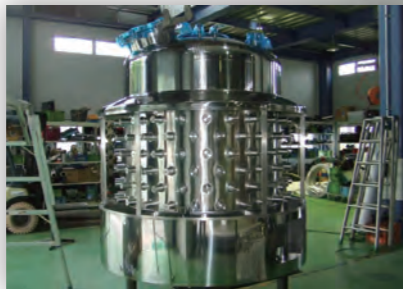
超音波結晶槽タンク SUS316 φ1300×H1500
